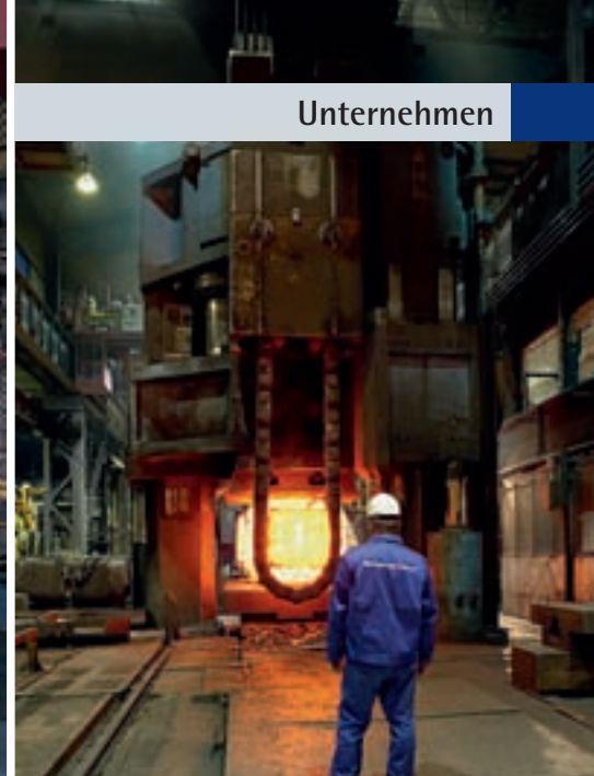
Schmiedeblock an der 55-MN-Freiformschmiedepresse
