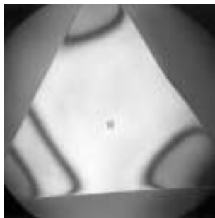
Ebenheitsprüfung an Makro-Platten Flatness test on macro blocks
