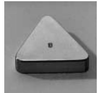
Knoop Härtevergleichsplatte Knoop hardness reference block
